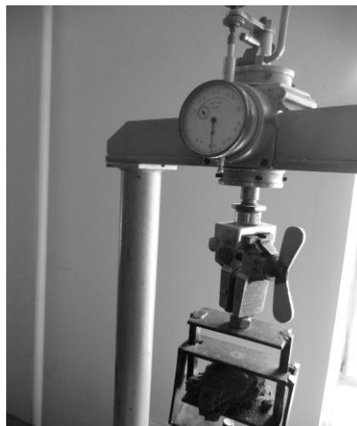
Рис. 3. Руйнування твердих включень нижнього промороженого сапропелю.
