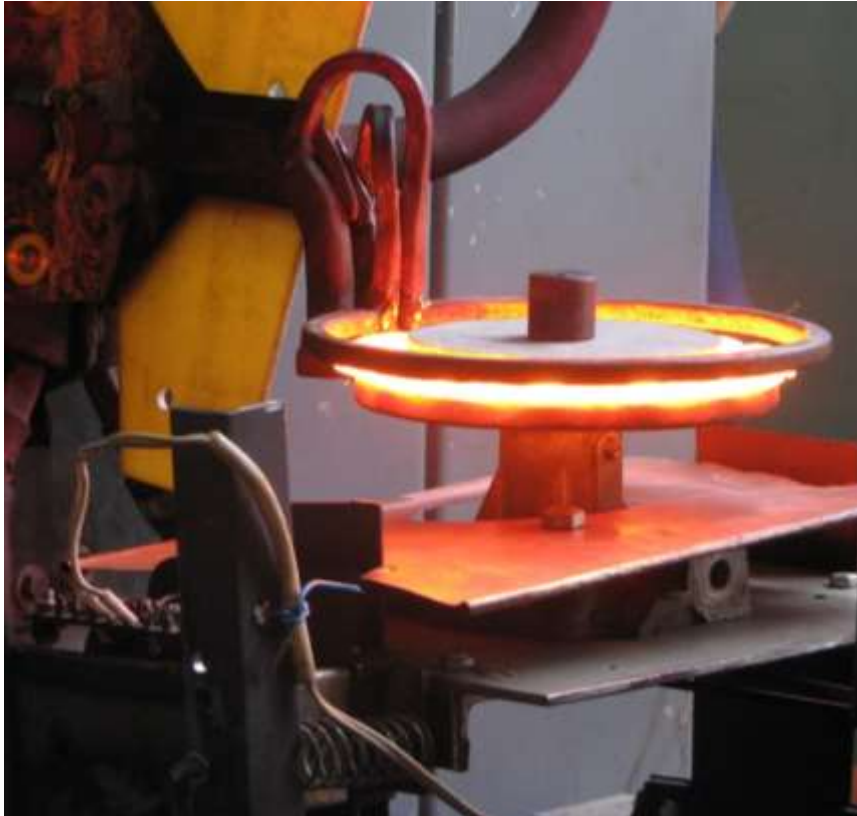
Рис. Установка для індукційного наплавлення з прикладанням горизонтальної вібрації в процесі наплавлення
