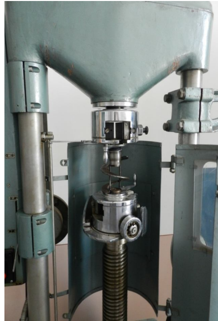
Рис. 2. Загальний вигляд машини на кручення КМ-50-1 з дослідними зразками секцій робочих органів
