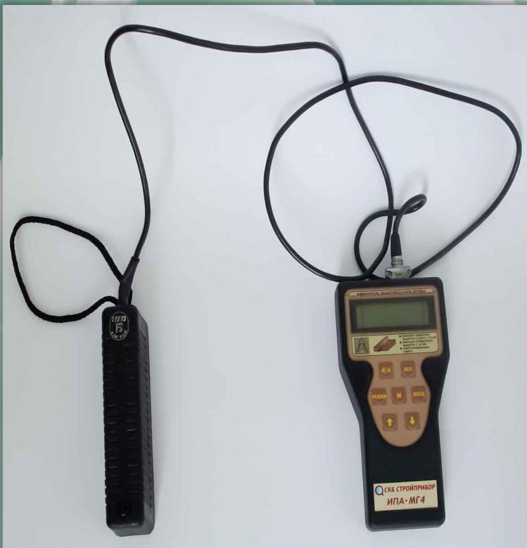
Прилад призначений для оперативного виробничого контролю товщини захисного шару бетону до 150 мм і розташування арматури в залізобетонних виробах і конструкціях магнітним методом у відповідності до ГОСТ 22904.
