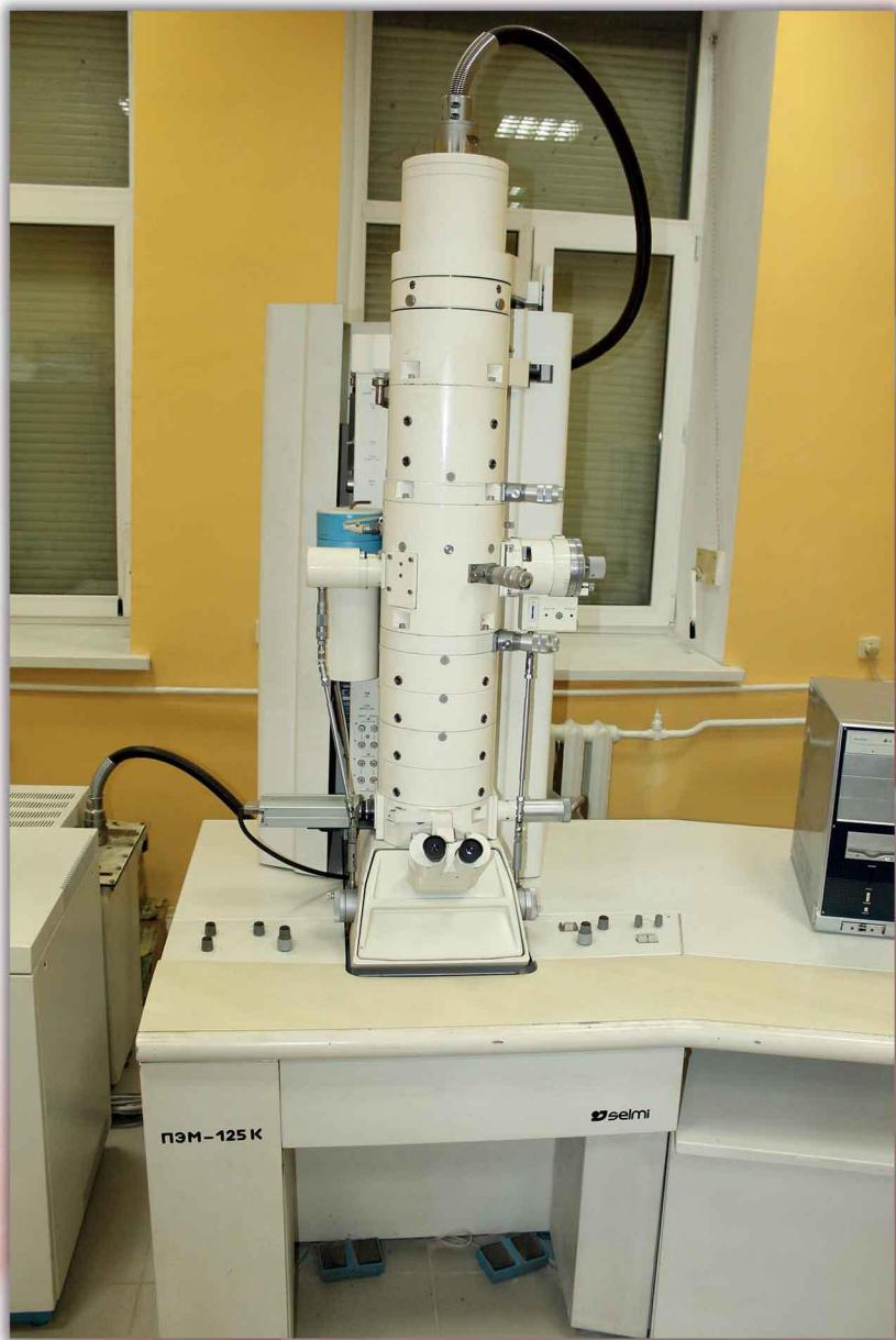
Просвічувальний електронний мікроскоп з комп'ютерним керуванням ПЕМ-125К призначений для дослідження мікроструктури та фазового складу об'єктів. З допомогою мікроскопа можливе візуальне спостереження і фотографування зображення об'єкта в широкому діапазоні збільшень, отримання дифракційної картини від об'єкта, дослідження об'єкта при його нахилі і обертанні. Мікроскоп оснащений системою комп'ютерного аналізу зображення САИ-01.
