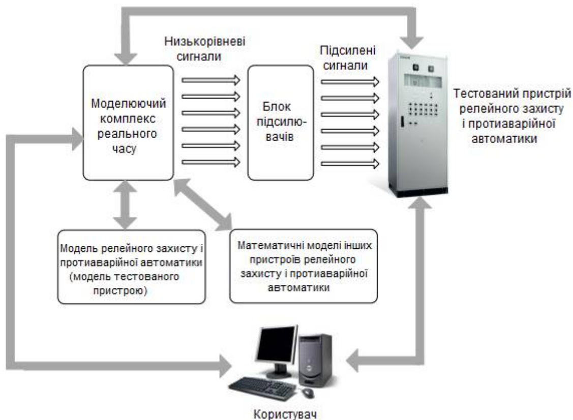
Рисунок 1 – Схема реалізації перевірки пристроїв релейного захисту та протиаварійної автоматики з використанням їх моделей
