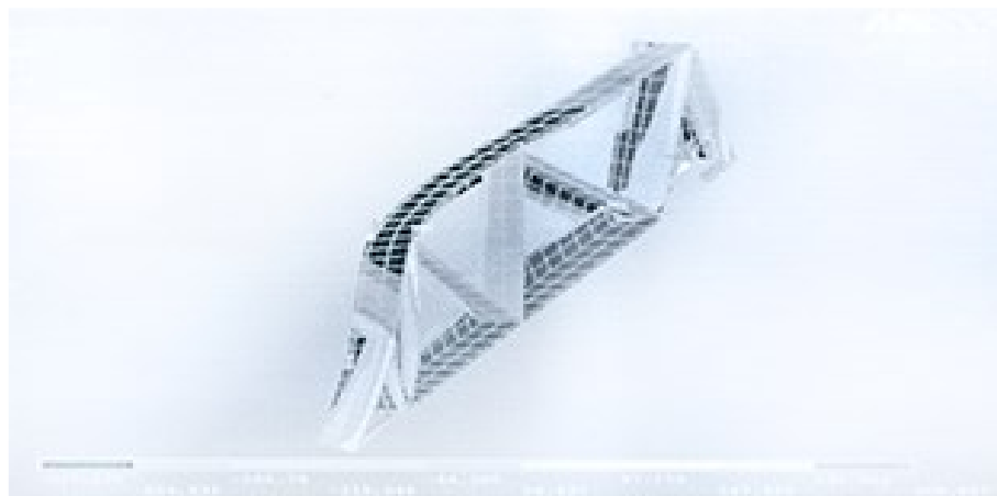
Рисунок 3.12 – Візуалізація поведінки фізичної моделі 600x120 зварної ферми за результатами комп'ютерного моделюючого експерименту при навантаженнях після втрати фермою поперечної стійкості
