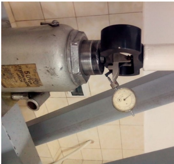
Рисунок 3.17 – Вимірювання досліджуваних величин за показами відлікових пристроїв динамометра ( а ) та індикатора ( б )
