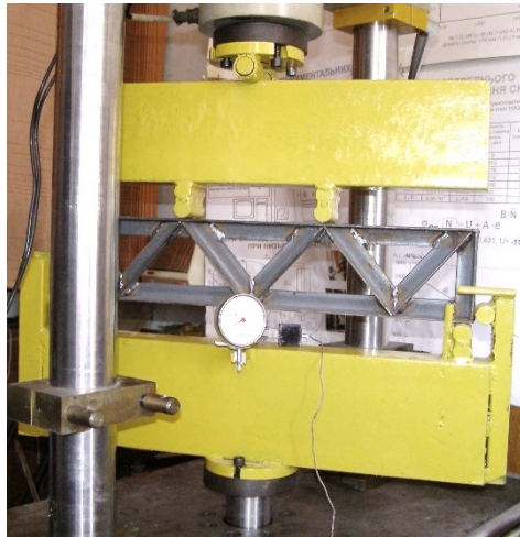
Рис. 3.8 – Зразок зварної ферми на випробувальному комплексі СТМ-100 перед навантаженням ( a ) та після руйнування ( б )
