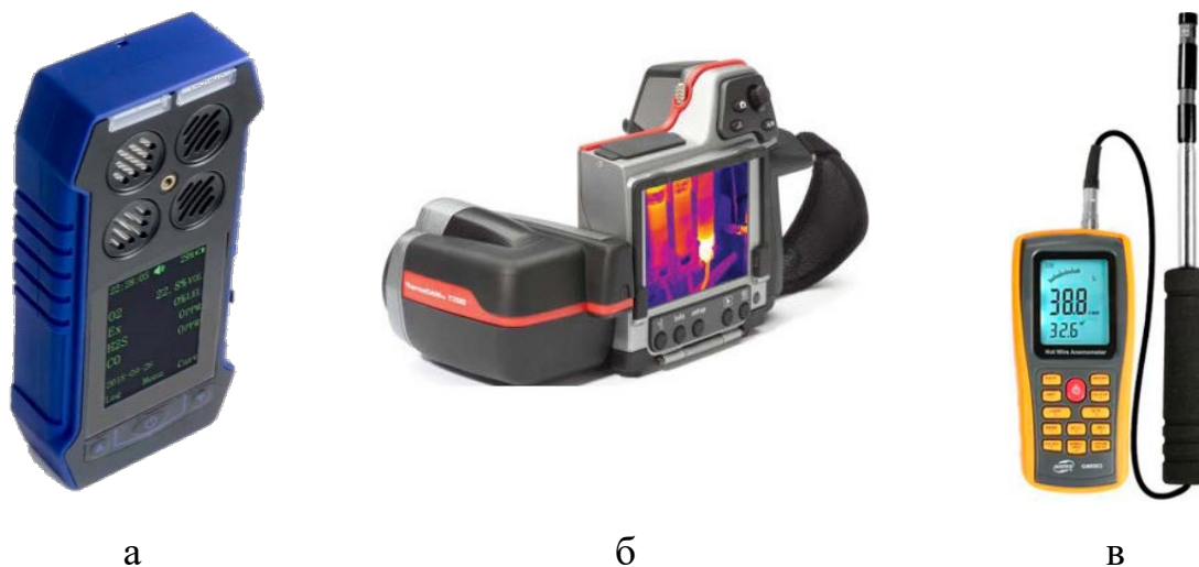
Рисунок 2.8 – Мультигазовий детектор WALCOM MGD-04 (а), тепловізор FLIR T200 (б) і анемометр Benetech GM8903 (в)
