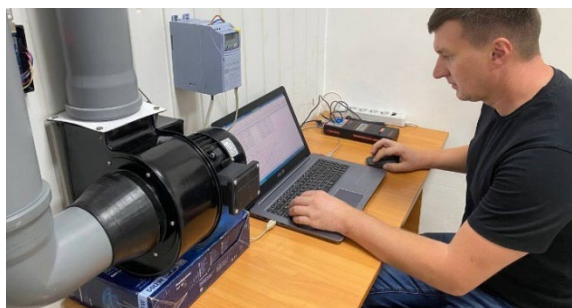
Рисунок Г.2 – Загальний вигляд лабораторного стану для дослідження вентиляційної системи видалення забрудненого повітря
