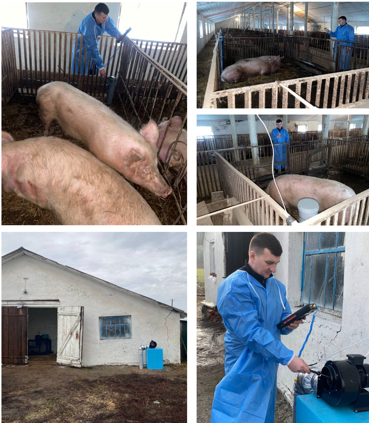
Рисунок Ж.1 – Процес експериментальних досліджень нагрівання потоку повітря у вертикальному ґрунтовому теплообміннику у виробничих умовах
