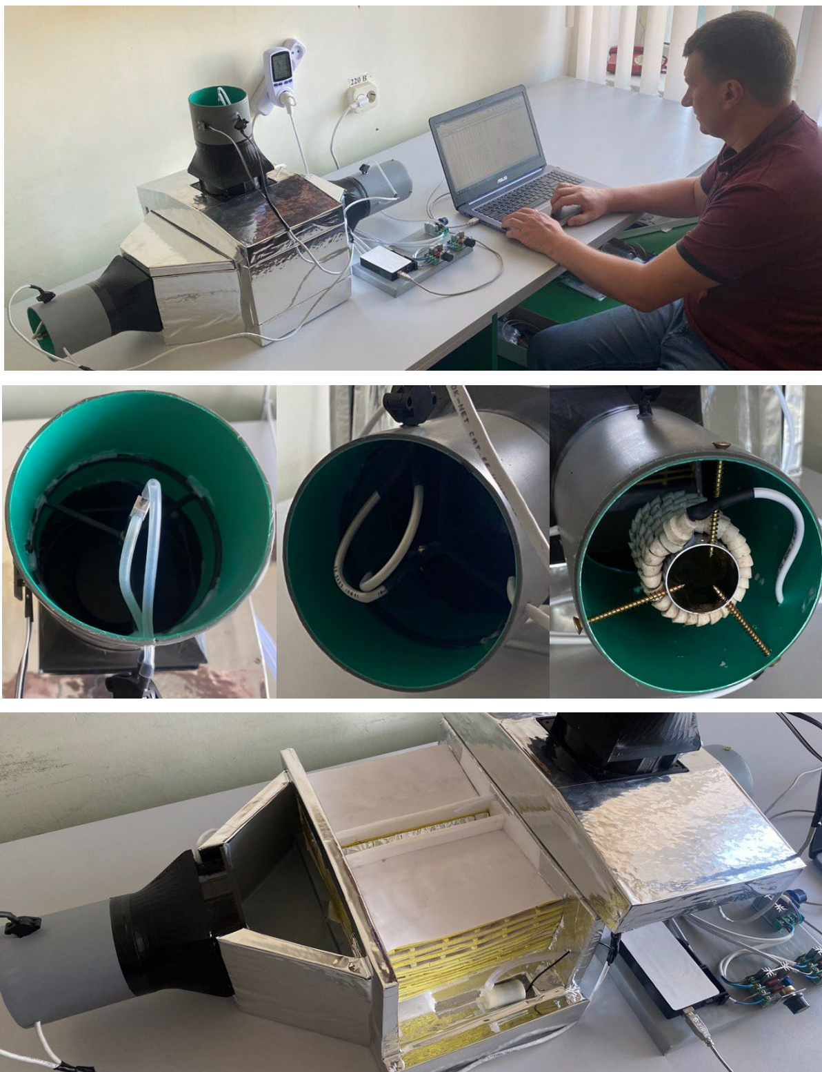
Рисунок Д.1 – Загальний вигляд лабораторного стану для дослідження теплообмінника побічно-випарного типу
