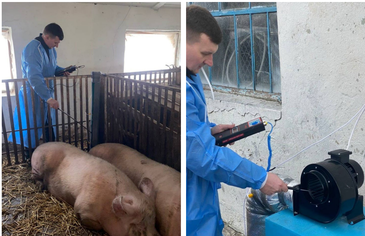
Рисунок 6.10 – Процес проведення досліджень вентиляційної системи нагнітання чистого повітря у виробничих умовах
