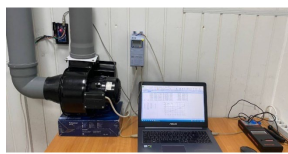
Рисунок Г.2 – Загальний вигляд лабораторного стану для дослідження вентиляційної системи видалення забрудненого повітря
