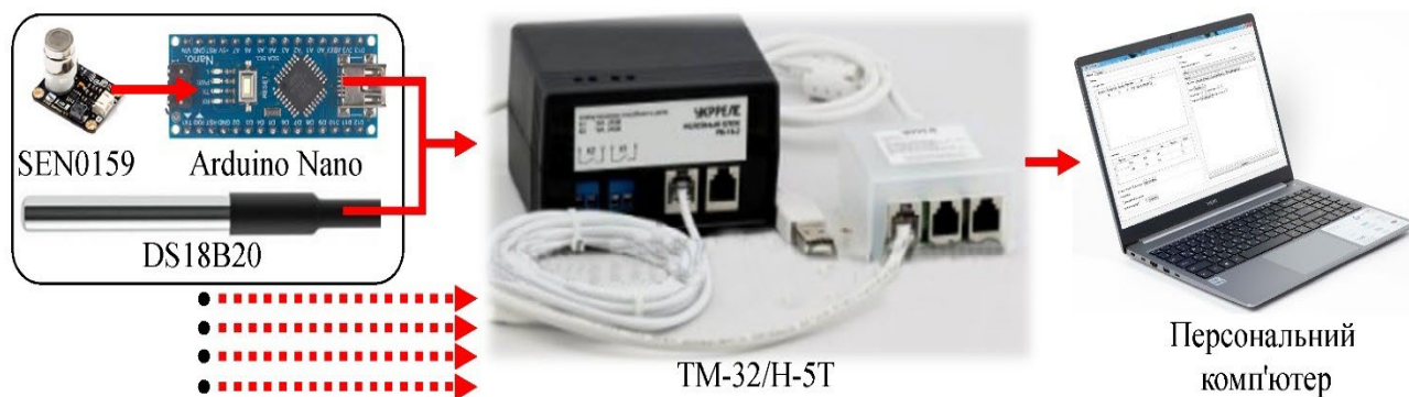
Рисунок 2.7 – Схема підключення датчиків
