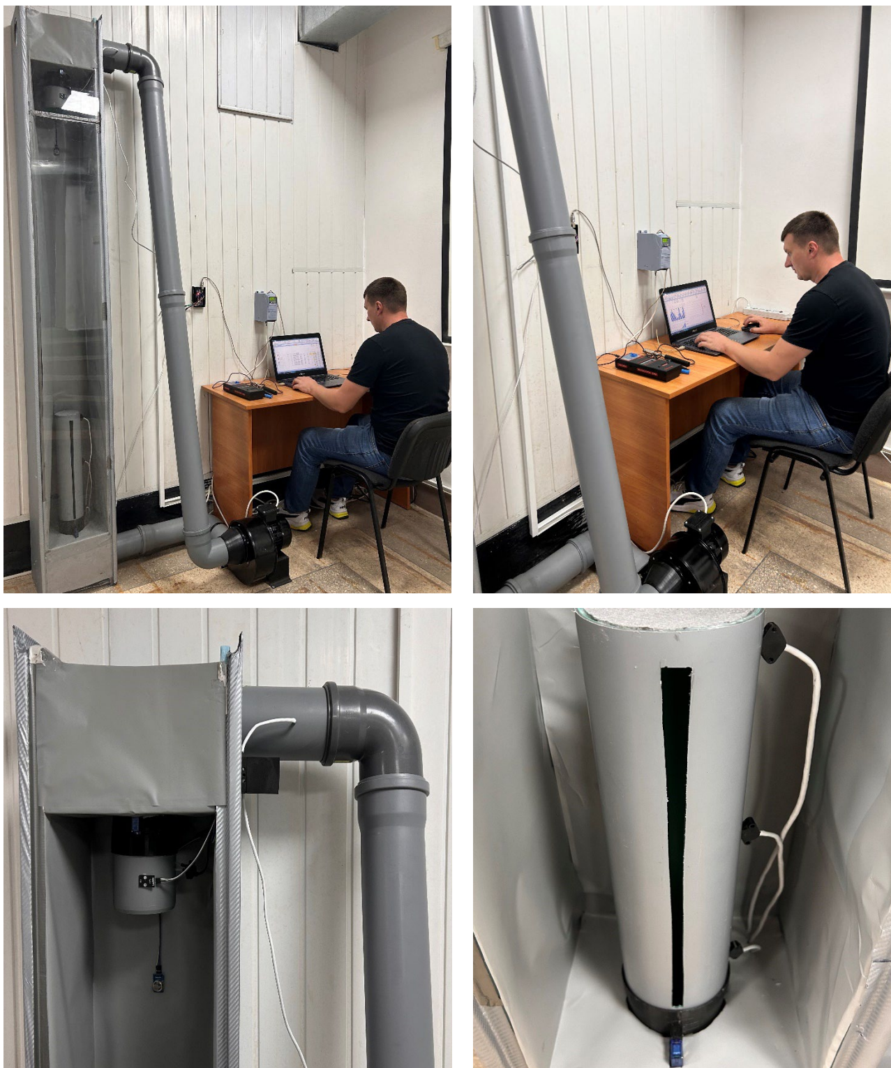
Рисунок Д.1 – Загальний вигляд лабораторного станду для дослідження патрубків для нагнітання повітря
