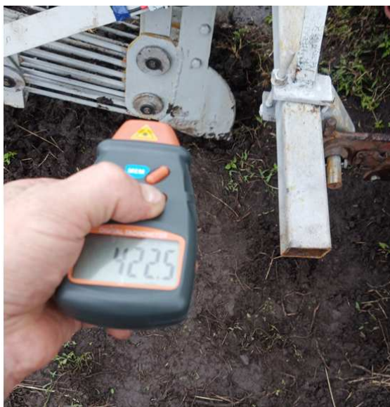
Рисунок 4.6 – Контроль і налагодження частоти обертання ВВП трактора
