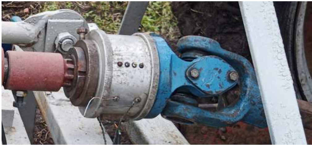
Рисунок 3.9 – Визначення крутного моменту приводу моментоміром
