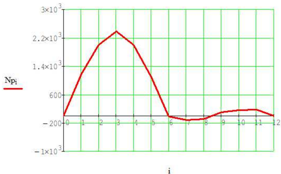
Рисунок 5.17 – Зміна споживаної потужності приводом лемеша
