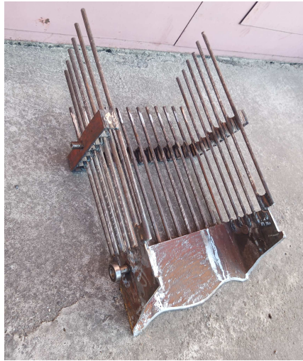
Рисунок 3.2 – Леміш картоплекопача (проміжна стадія виготовлення дослідного зразка)
